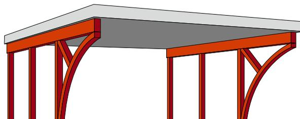
**Länge und Radius des Leimholzbogens sind immer gleich. Bei Überschreiten der Carport-Standardhöhe wird der Leimholzbogen angehoben und kann optional mit einem Passstück verlängert werden.**
