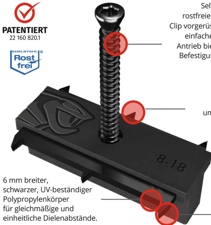
Selbstbohrende Schraube aus rostfreiem Stahl werkseitig auf dem Clip vorgerüstet für eine schnellere und einfachere Implementierung. Torx-Antrieb bietet Komfort und Präzision. Befestigung in Holz oder Aluminium.
