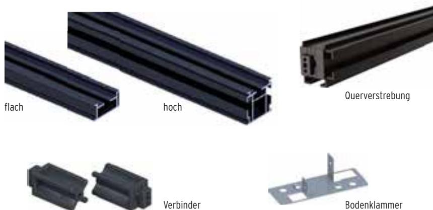
Die **Unterkonstruktion aus Aluminium** (ALU UK) ist extrem haltbar und verwindungsstabil. Die UK „hoch“ (40 x 40 mm) kann mit Hilfe der Verbinder (2068) zu einem verzugsarmen Rahmen montiert werden. Fixieren Sie die UK mit den Bodenklammern am Untergrund. Durch den Einsatz von **Querverstreibungen** stellen Sie eine verbindungssteife Unterkonstruktion sicher. Bitte nutzen Sie die DREAMDECK ALU Aufbauanleitung für weitere Informationen.
