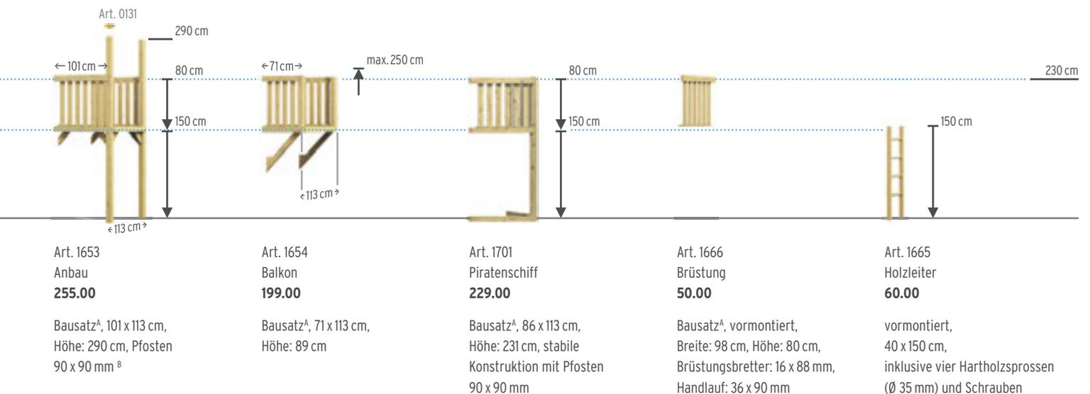
Anbau und Balkon können auch als eine „tiefere“ oder „höhere“ Ebene montiert werden. Genaue Hinweise hierzu liefert Ihnen die WINNET00 Aufbauanleitung. <sup>B</sup> Die Pfostenüberstände können Sie mit der Pfostenkappe (Seite 50) abdecken.
